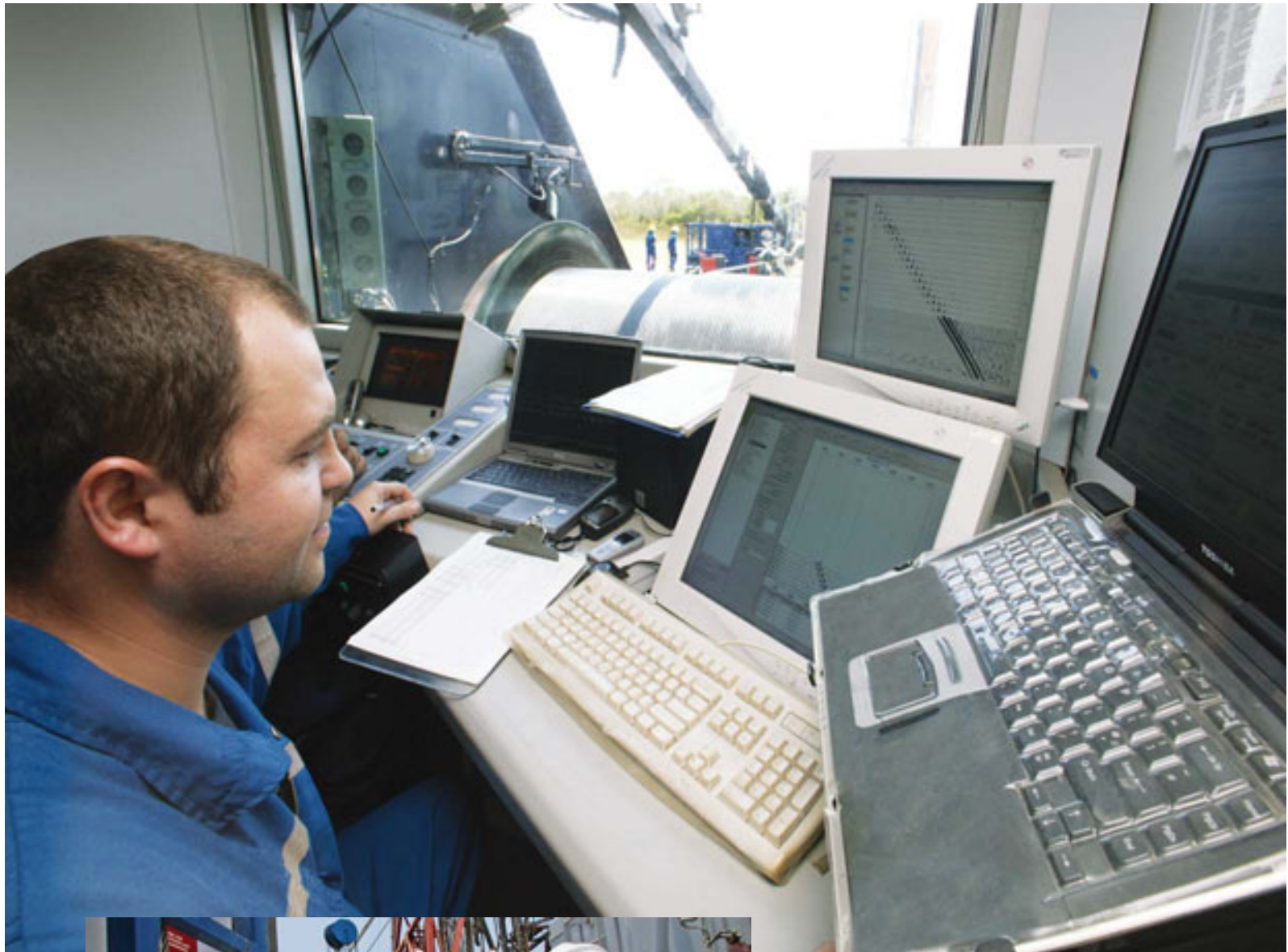
Mexique - Emil Oniga, ingénieur Logging, enregistrant un profil sismique vertical sur le gisement de Paredon, près de Villahermosa.
