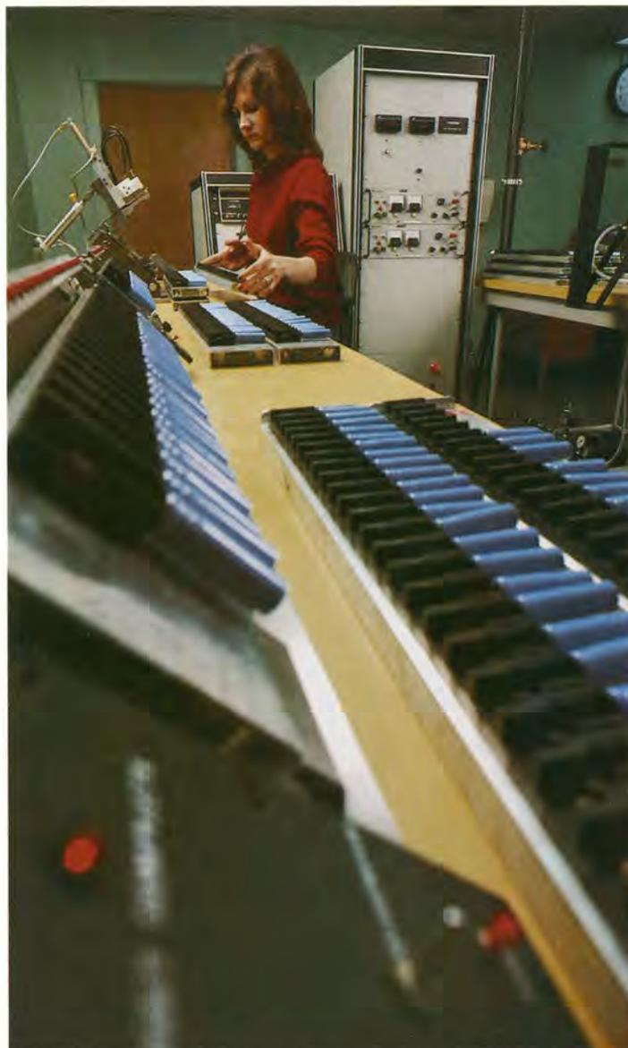
*Miranda Chapman prépare un équipement de test en vue du contrôle automatique d'une série de condensateurs électrolytiques, à l'usine de Pickens, en Caroline du Sud.*
