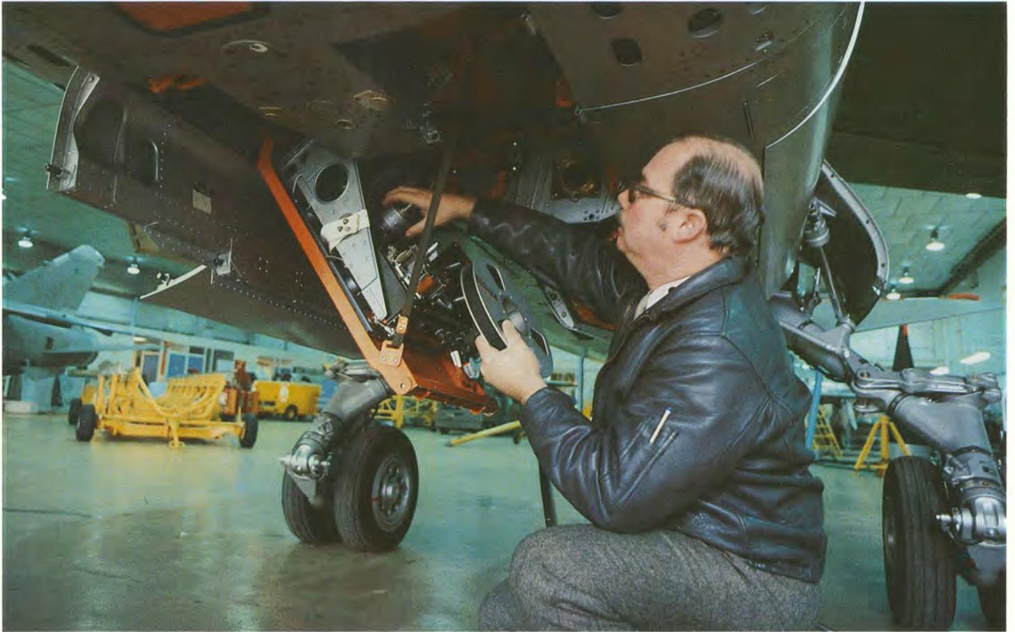
*A la base de Brétigny, installation d'un enregistreur magnétique à bord d'un Mirage. Cet enregistreur compact est utilisé pour recueillir les données d'essai en vol.*
