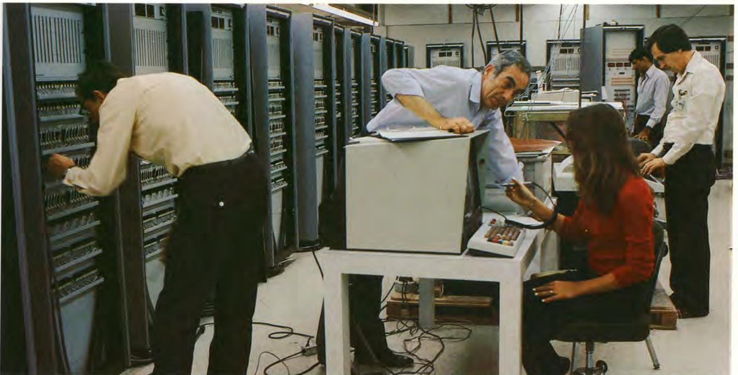
La dernière mise au point d'un système centralisé de commande pour champs pétroliers, à la division Systèmes de données de Sangamo Weston, à Sarasota, en Floride. Ce système est destiné au contrôle de la production de puits offshore, dans le golfe d'Arabie.
